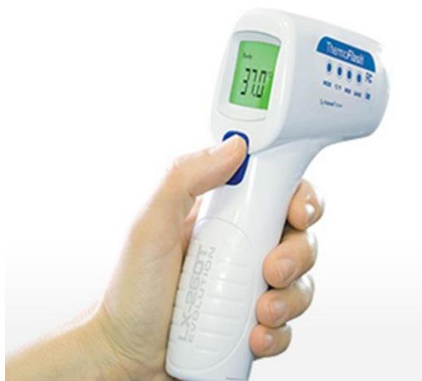
Grâce au ThermoFlash, vous pourrez aussi bien prendre la température de votre corps, que celle de l'air ambiant ou bien celle d'une surface grâce au bouton « mode » du panneau de contrôle.
